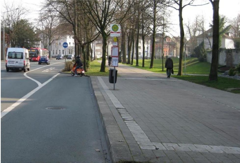
*Abbildung 19: Bodenindikatoren aus Rillenplatten sind für Blinde nur schwer zu ertasten und neigen weiterhin zur Verschmutzung (Beispiel: Haltestelle Gierstor)*
