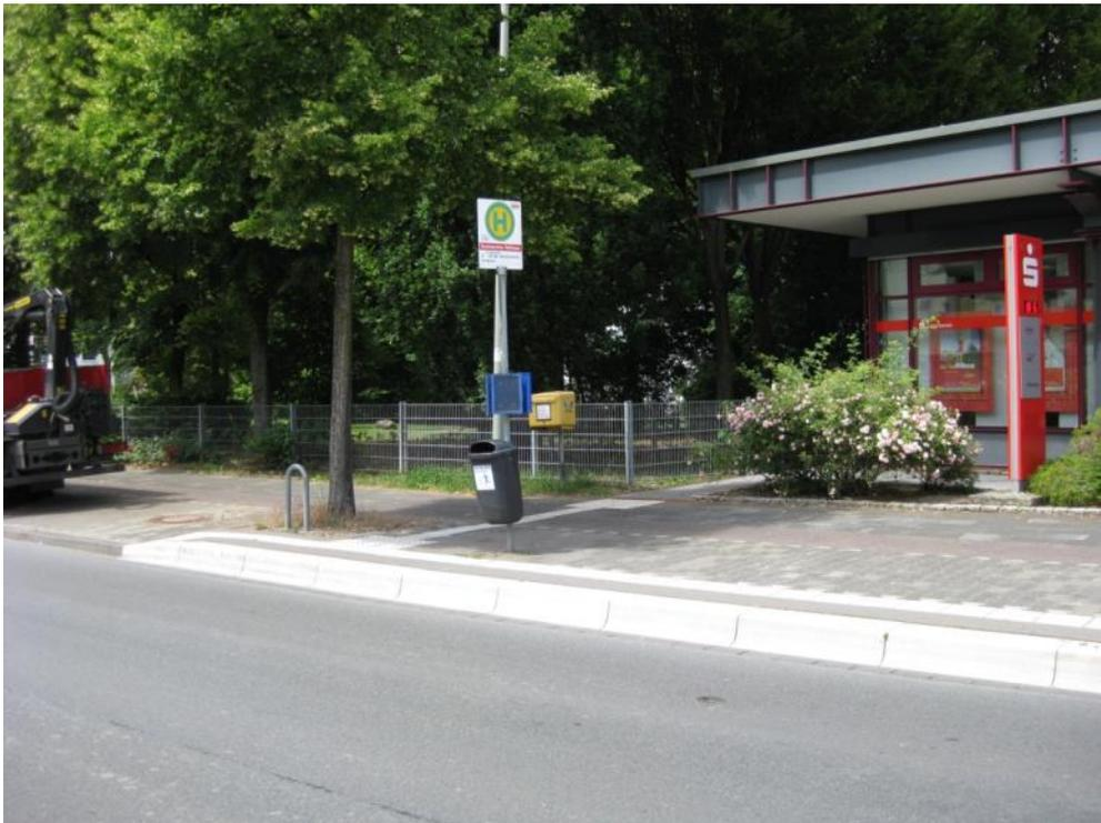
Abbildung 14: Nach aktuellem „Stand der Technik“ ausgebaute Haltestelle mit Ausbildung als Buskap, niederflurgerechtem Sonderbord und taktilem Leitsystem aus Bodenindikatoren (Beispiel: Haltestelle Technisches Rathaus)
