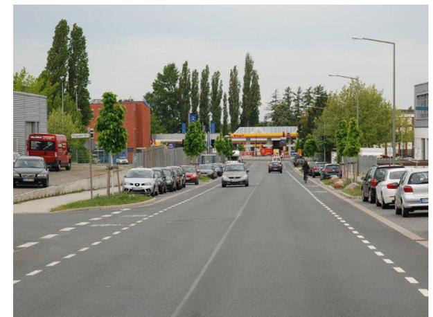
Abb. 72: Beidseitiger Schutzstreifen auf Hauptverkehrsstraßen
