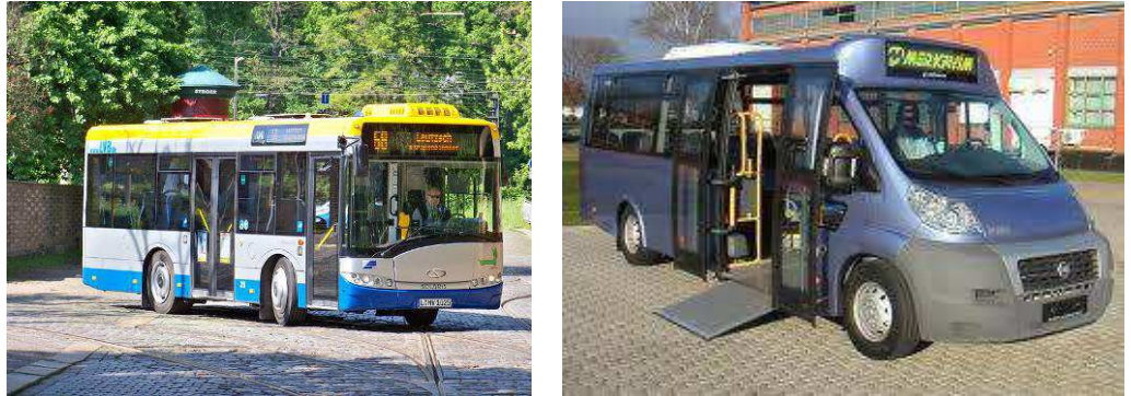
Abb. 30 Beispiele für einen Midibus (links) und einen Minibus (rechts)
