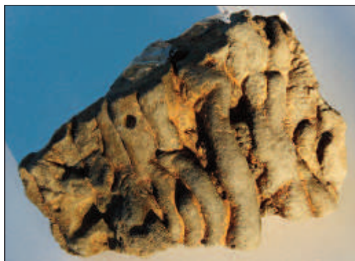
Abb.7: Eisenschlacke aus dem Schwarzbachtal südlich der Bleikuhlen (Nach Mitteilung von M. Schleicher, Blankenrode, evtl. aus mittelalterlicher Rennofenverhüttung) (Foto: Gerhard Müller)
