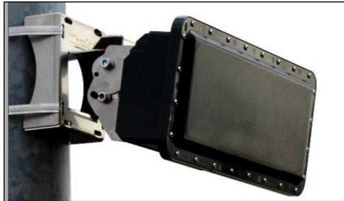
Abbildung 11: Aufnahme eines winkelauflösenden Radars
