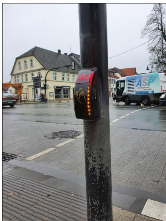
Abbildung 8: Fotoaufnahme eines Radar-Tasters an der Schloßkreuzung
