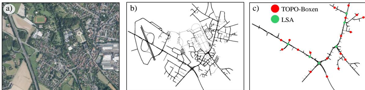
Abbildung 2: Vogelperspektive des realen Testgebiets in a), OSM-basiertes SUMO-Netz in b) und dessen Reduktion auf Hauptstraßen mit den Standorten von TOPO-Boxen und LSA in c)
