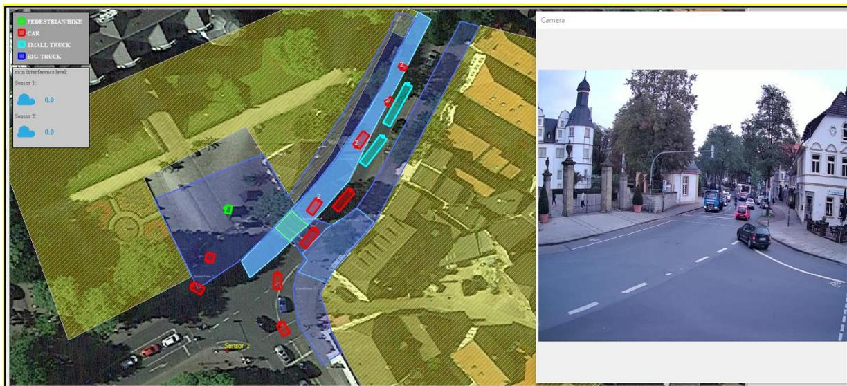
Abbildung 12: Vergleichende Beispielaufnahmen des winkelauflösenden Radars an der Schloßkreuzung mit zusätzlicher Markierung der Sensierungsgebiete und Fahrzeuge
